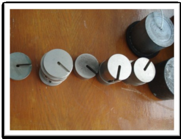
Рисунок 17 - Груз (гири массой от 0,1 до 15 кг), использованный для экспериментальных тестов
