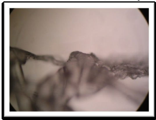
Рисунок 7 - Микрофото. Линия среза имплантата ультразвуковыми ножницами с острыми браншами. Увеличение 10x10.
